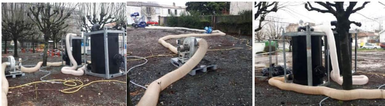
Figure 2 : Extracteur d'air, filtres à charbon actif et gaines
